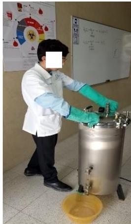
*NOTA:* Proceso de esterilización en autoclave (degradación de microorganismos por calor húmedo) llevado a cabo por estudiantes para inactivar los agentes biológicos y asegurar que no representan ningún riesgo tanto para la salud pública como al del medio ambiente.
